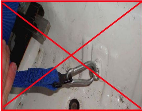
Karabijnhaak niet toegestaan voor montage gordel.
